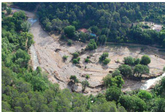
Photos 32 : La Floriège à Lorgues - Coupure de méandre au droit de St t Barthélémy - Post crue
